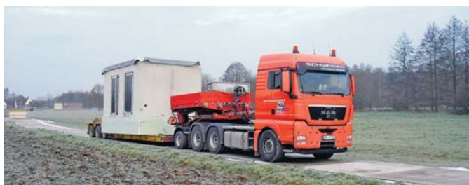
Das Fertigteilgebäude rollt an: Für den 35-Tonnen-Schwertransport musste eine Spezialzufahrt errichtet werden.
