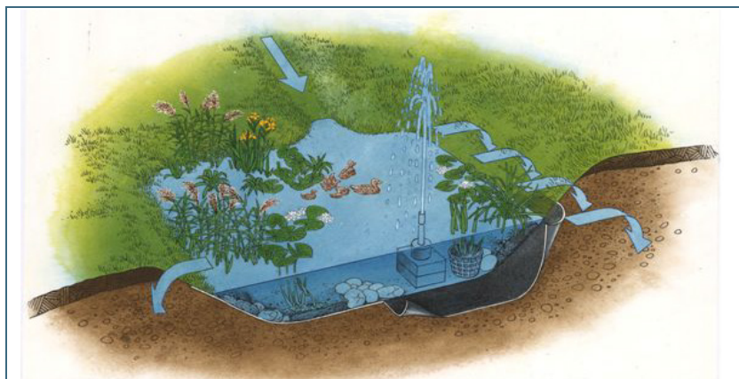
Abb. 6: Abfließendes Wasser kann auch in einen Sickerteich geleitet werden. Im Beispiel versickert das Wasser nicht am Grund, sondern an den oberen Rändern des Teichs. Der Sickerteich kombiniert Versickerung und Rückhaltung.
