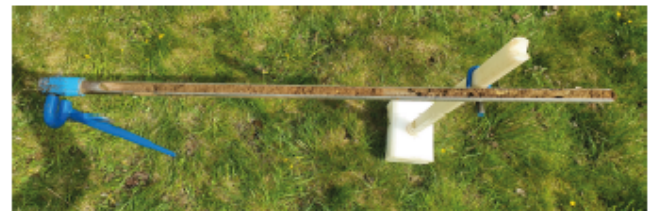
Abbildung des zum Einsatz kommenden "Pürckhauer"-Bohrstock
