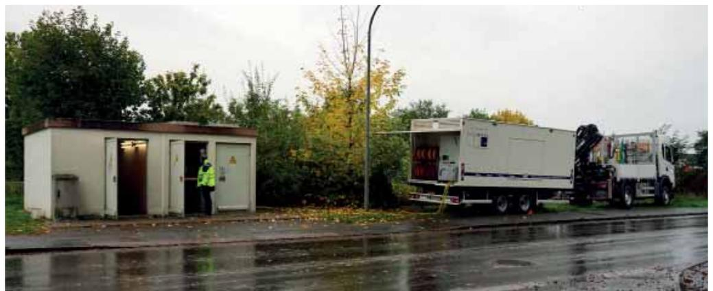
Mit dem mobilen Notstrom-Aggregat konnten die Stadtwerke die Spannungsumstellung für die Anlieger störungsfrei durchführen.
