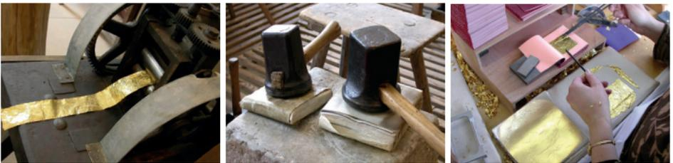
Der letzte Schlagvorgang benötigt rund 5000 bis 7000 Schläge; zwischen zweieinhalb und sechs Stunden dauert diese Prozedur. Die Spezialhämmer, mit denen die Goldschläger arbeiten, haben ein Gewicht zwischen 2 und 12,5 Kilogramm. Den Vorgang des Einlegens und Vierteln besorgen die Goldzurichterinnen.
