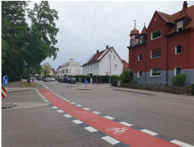
Abbildung 14: Roteinfärbung an vorfahrtsregelten Knotenpunkten
