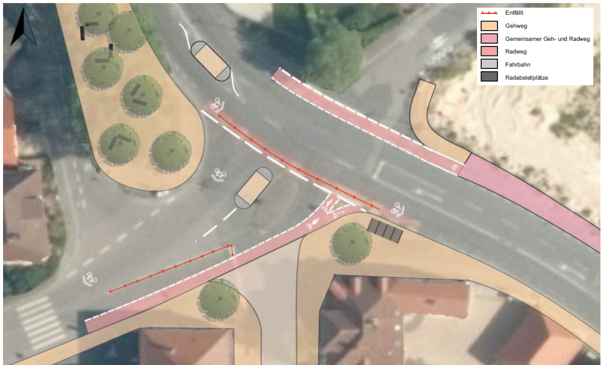
Abbildung 63: Maßnahmenskizze Knotenpunktumgestaltung Innenstadtzugang am Nördlinger-Tor-Platz V1
